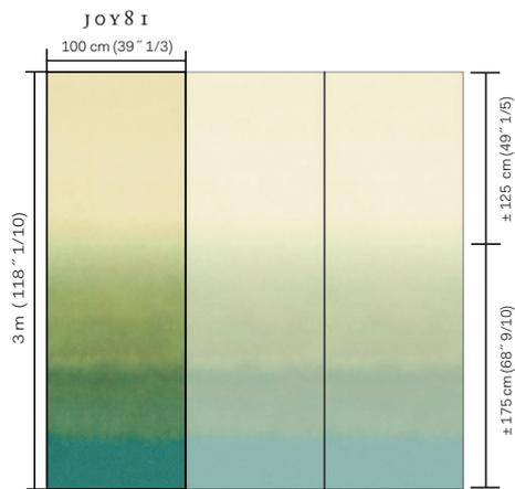
JOY8 ist ein Panorama Design, bestehend aus ein Panel. Es kann endlos erweitert werden. Die Abmessung der Panel beträgt 1 x 3 m. Sonderhöhe auf Anfrage.
